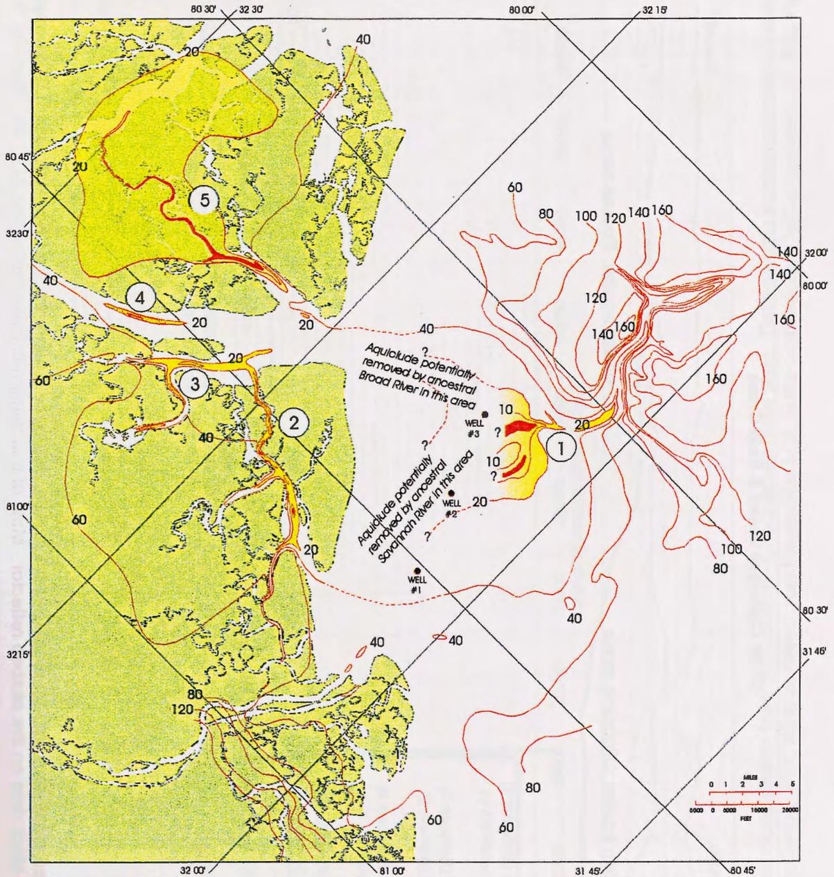
**MIOCENE AQUICLUDE ISOPACH MAP**      ■ AQUICLUDE ABSENT      ■ AQUICLUDE LESS THAN 20 FT THICK
